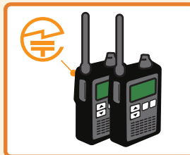
トランシーバー:裏面または内蔵バッテリーを取り外した部分
